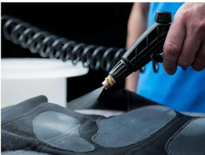
Sprühpistole betätigen und Elektroden anfeuchten; Pumpe stoppt nach Beendigung des Sprühvorgangs
